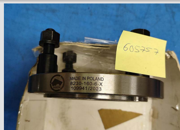
Št. 26: 3- čeljustna vpenjalna glava Ø 160 mm Podjetje Röhm
